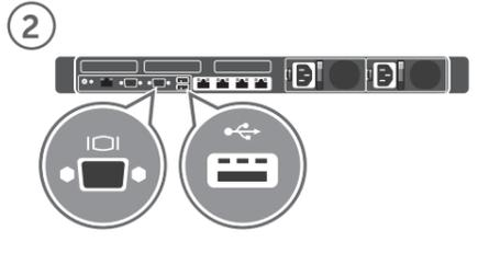
キーボード、マウス、およびモニター（オプション）を接続します。 키보드, 마우스 및 모니터를 연결합니다(선택 사양)。
