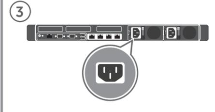
시스템을電源に接続します。 시스템을 전원케이블로 연결합니다。
