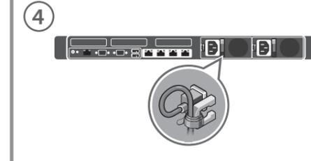
電源ケーブルを束ね、固定クリップを使用して固定します。 고정 클립을 사용해 전원 케이블을 순환시키고 고정합니다。
